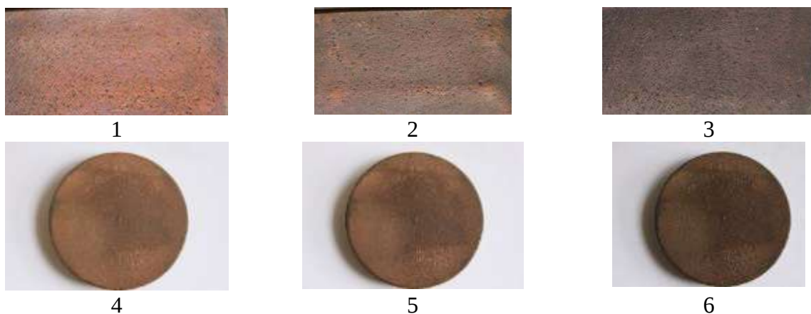
Рисунок 2 – Исследуемые образцы: 1, 2, 3 – патинирование «серной печенью» с разным временем выдержки, 4,5,6 – патинирование азотно-кислым серебром с последующим отжигом
